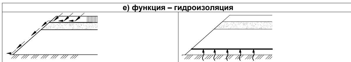
Рисунок 4.1 Основные функции геосинтетических материалов в дорожных конструкциях
