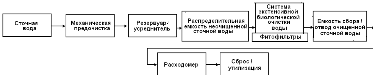
Рис.1. Технологическая схема экстенсивной биологической очистки сточных вод в фитофильтрах (фильтрах, засаженных макрофитами)
