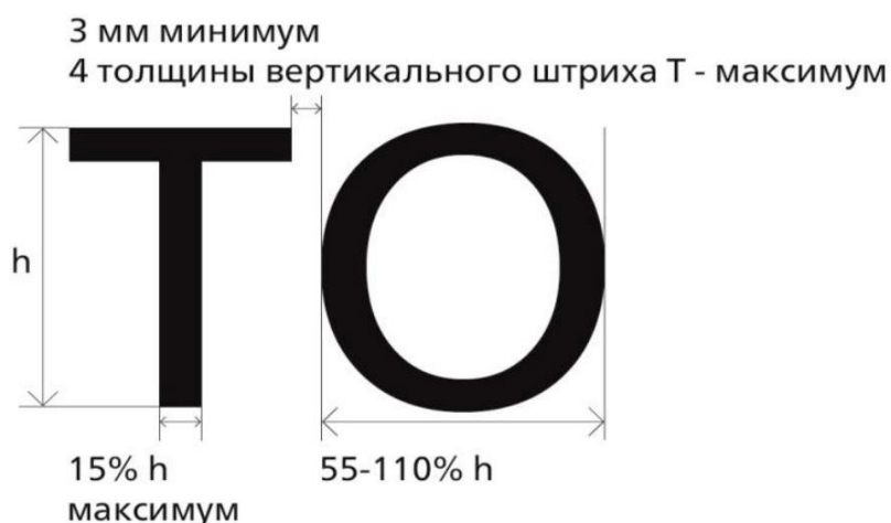
Рисунок 24 — Пропорциональные соотношения элементов шрифтовых знаков
