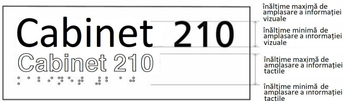
Figura 5 — Axele înălțimilor minimă și maximală de amplasare a informației vizuale și tactile
