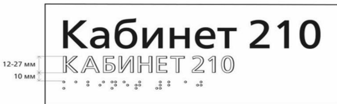
Рисунок 33 — Высота РЛШ при совмещении визуальной и тактильной информации (в данном случае знаки РТШ рекомендуется выполнять прозрачными или в цвет подложки)
