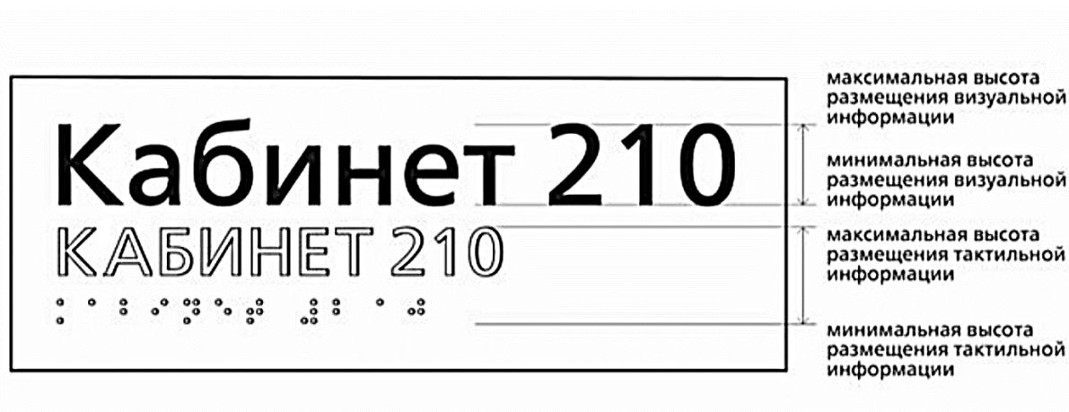
Рисунок 5 — Оси минимальной и максимальной высот размещения визуальной и тактильной информации
