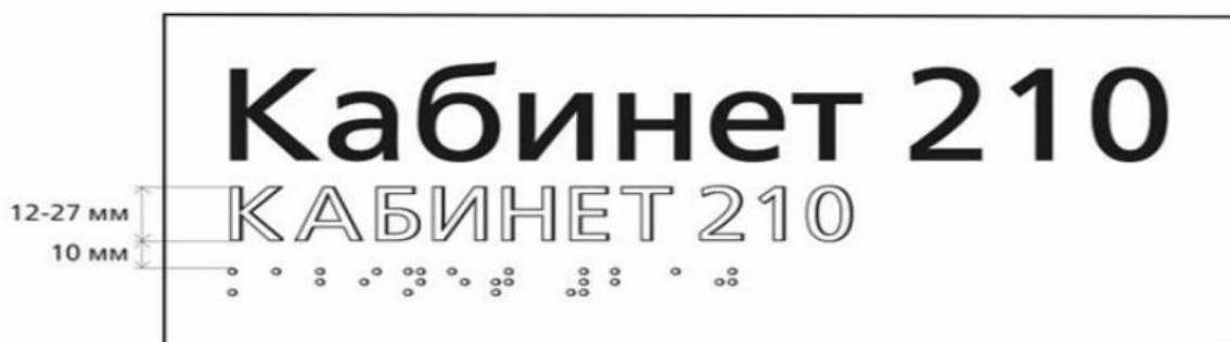
Рисунок 32 — Высота РЛШ при сочетании с плоскопечатным шрифтом (в данном случае знаки РЛШ и РТШ рекомендуется выполнять прозрачными или в цвет подложки)
